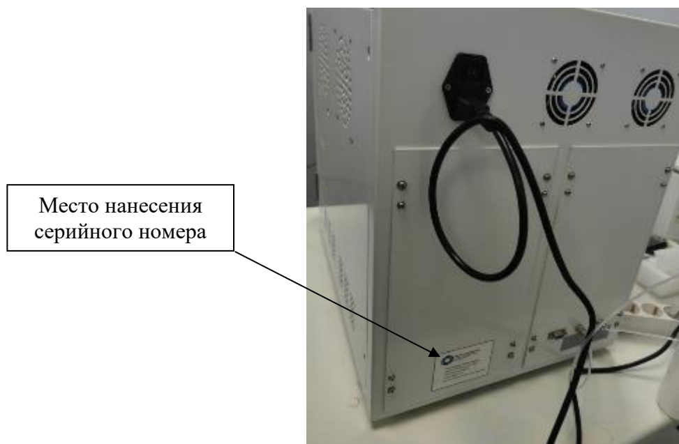
Рисунок 2 – Место нанесения серийного номера на анализаторы общего органического углерода с инфракрасным детектированием INSPIRION TOC
