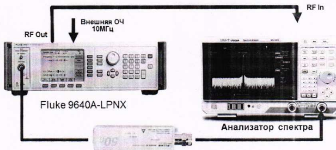
Рисунок 2 - Схема соединения приборов для определения абсолютной погрешности измерения опорного уровня на частоте 50 МГц
