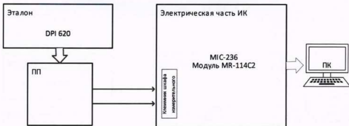
Рисунок 16 – Схема поверки ИК давления газов и жидкостей комплектным способом
