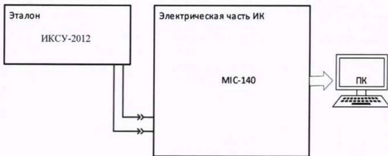
Рисунок 17 – Схема поверки напряжения постоянного тока, соответствующего значениям температуры в диапазоне преобразований ПП термоэлектрического типа ХА (К), ХК (L)
