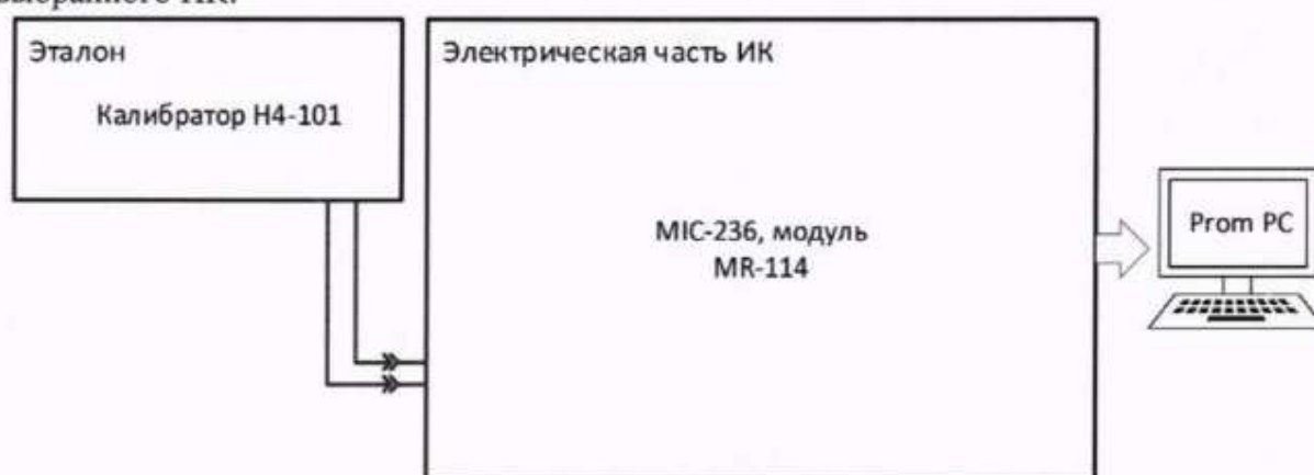
Рисунок 20 – Схема поверки электрической части ИК напряжения постоянного тока
