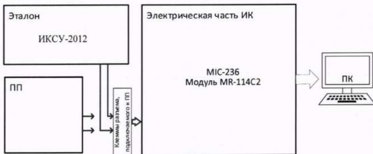
Рисунок 13 – Схема поверки ИК прокачки масла поэлементным способом
