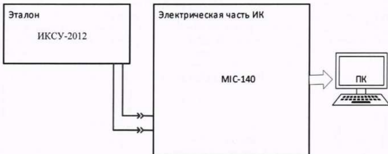
Рисунок 18 – Схема поверки ИК температуры, измеренной ПП термоэлектрического типа ХК (L)
