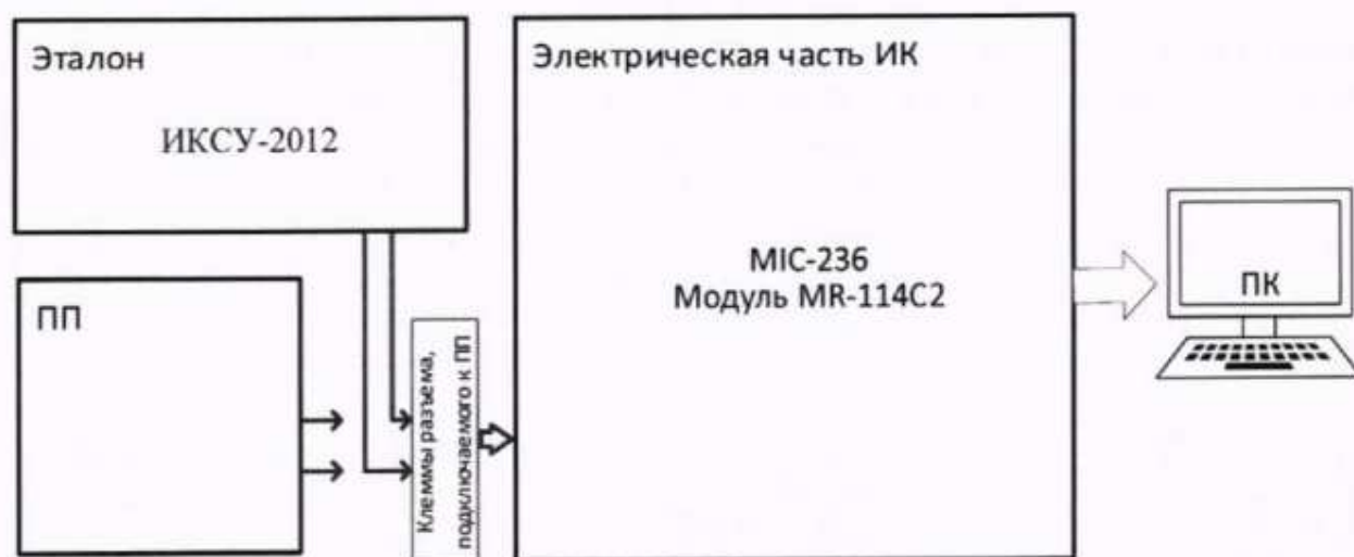
Рисунок 12 – Схема поверки ИК расхода топлива поэлементным способом
