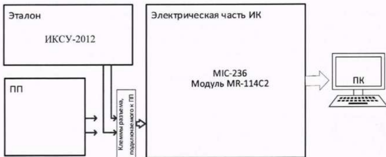
Рисунок 15 – Схема поверки ИК давления газов и жидкостей поэлементным способом
