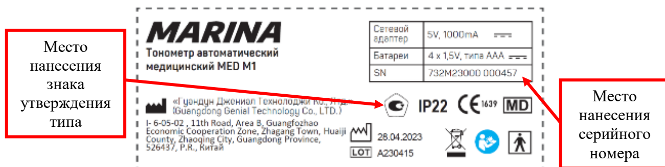
Рисунок 5 – Общий вид маркировки, расположенной на обратной стороне корпуса электронного блока с указанием места нанесения серийного номера и знака утверждения типа
