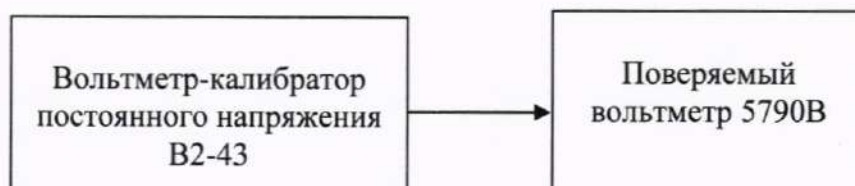
Рисунок 3 - Схема соединения приборов при определении основной погрешности вольтметра в режиме измерений постоянного электрического напряжения
