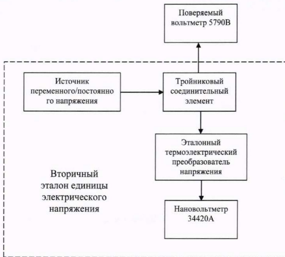
Рисунок 2 - Схема соединения приборов при определении основной погрешности вольтметра в режиме измерений переменного электрического напряжения.
