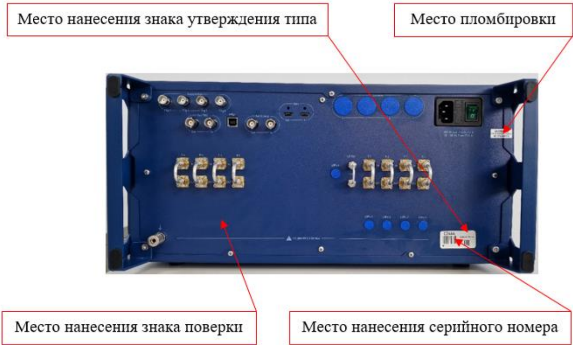
Рисунок 2 – Схема пломбировки от несанкционированного доступа
