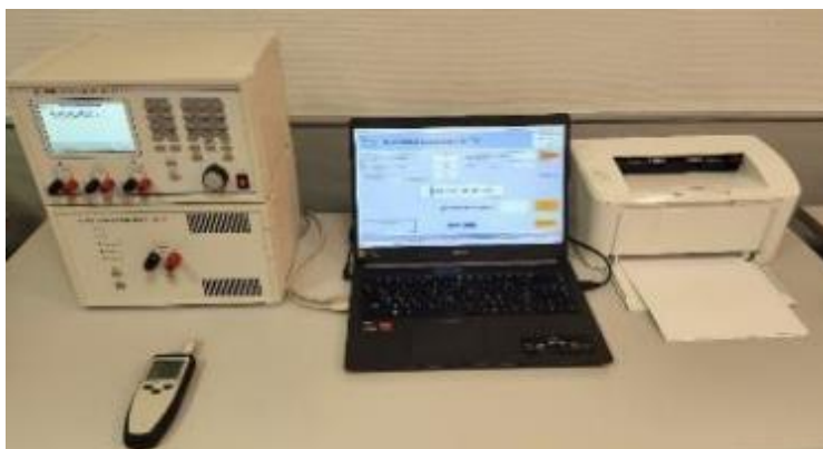
Рисунок 2 – Общий вид ИК воспроизведения электрических величин СИ и ИС тягового подвижного состава
