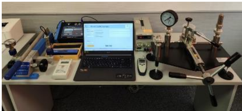
Рисунок 3 – Общий вид ИК воспроизведения и измерения параметров давления и вакуума СИ и ИС тягового подвижного состава
