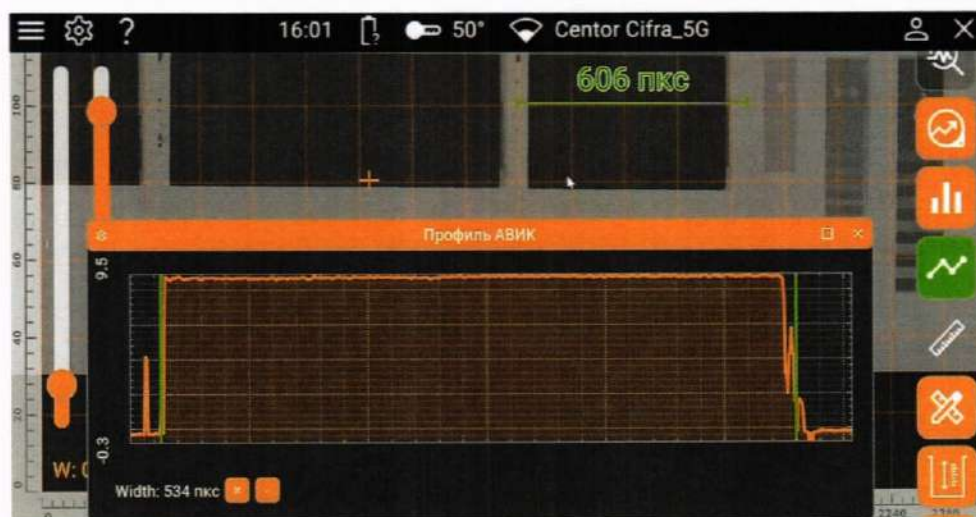
Рисунок 2 – Формируемый курсорами отрезок профиля и соответствующий график профиля
