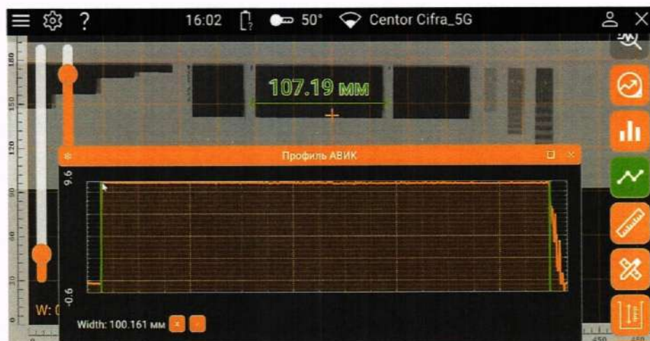
Рисунок 5 - Установка вертикальных маркеров на графике профиля для измерения длины
