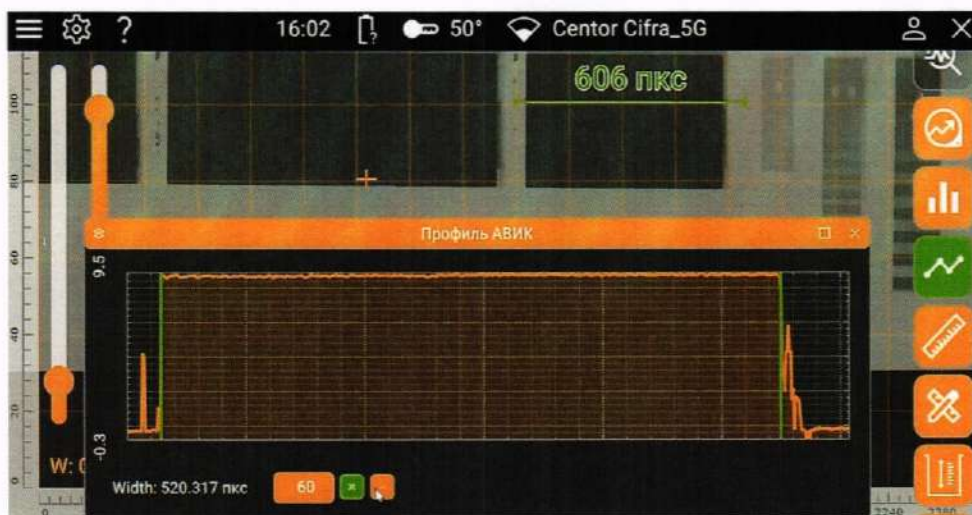
Рисунок 4 – Установка горизонтальных маркеров на графике профиля при выполнении калибровки
