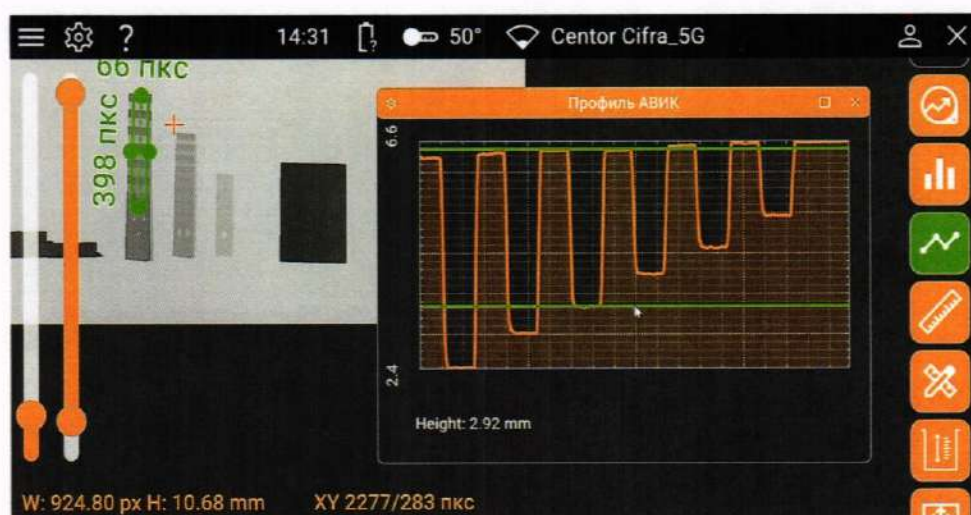
Рисунок 8 - Установка горизонтальных маркеров на графике профиля для измерения глубины
