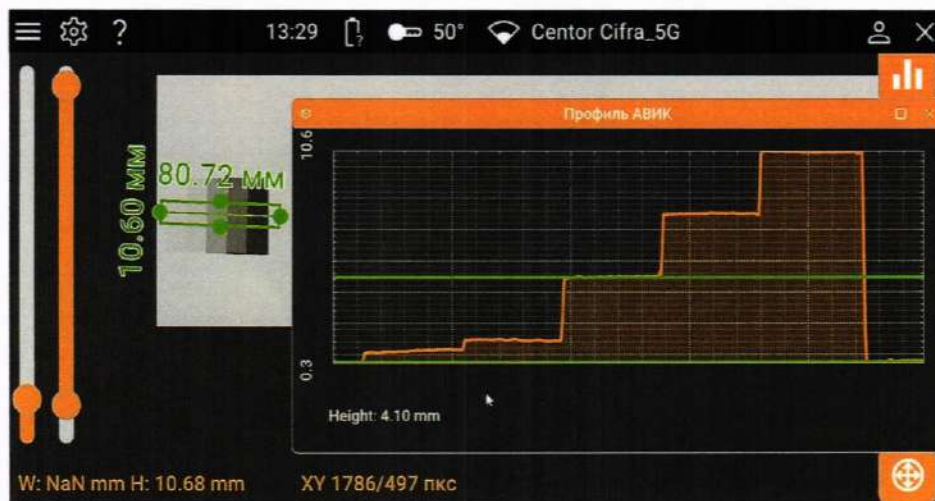
Рисунок 7 – Формируемая курсорами плоскость профиля и установка горизонтальных маркеров на графике профиля для измерения высоты
