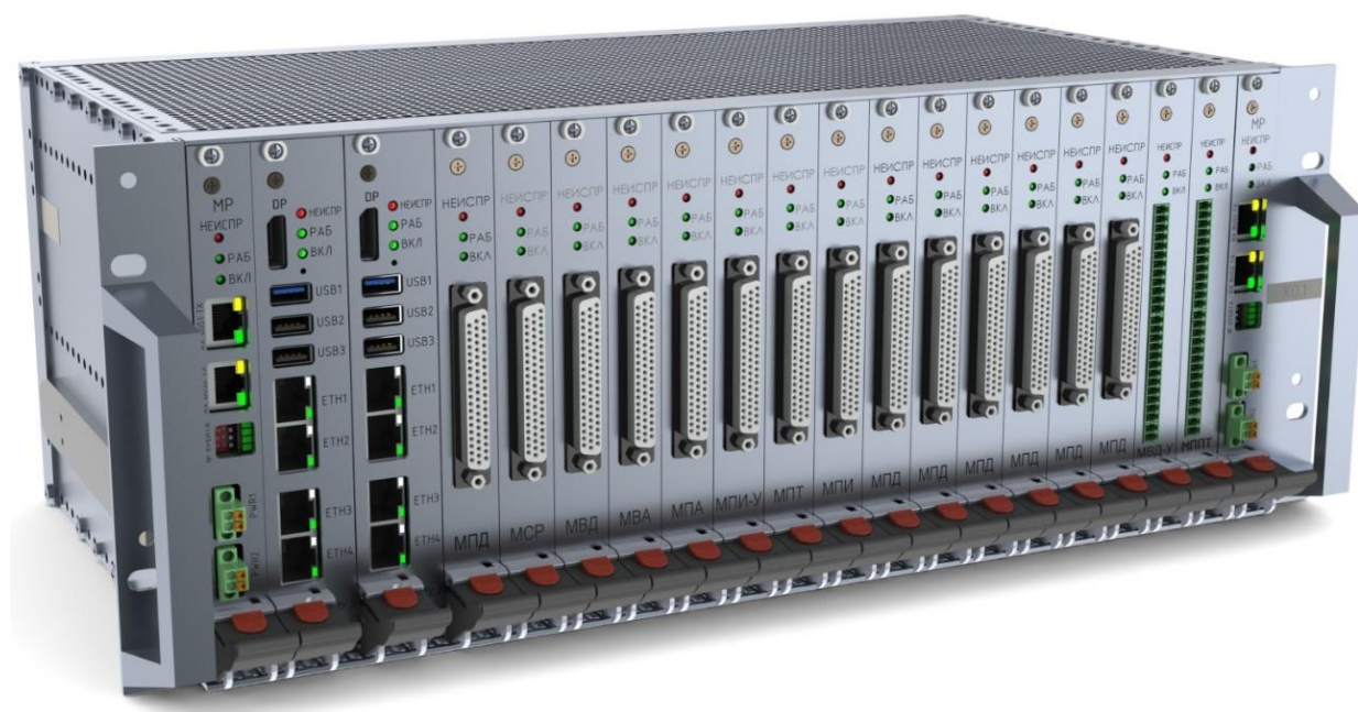
Рисунок 1 – Внешний вид КО.1 с установленными модулями
