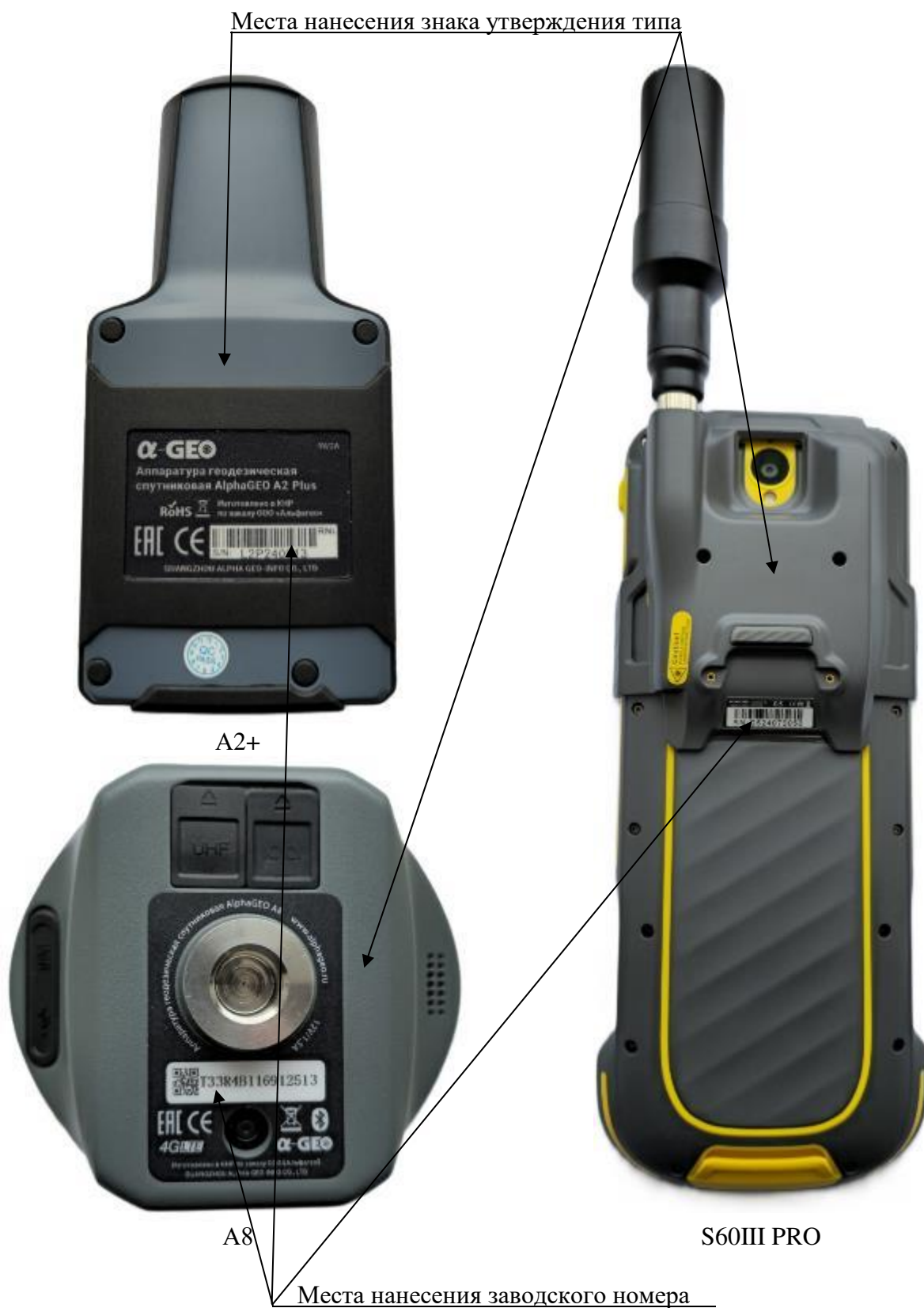
Рисунок 2 – Вид аппаратуры со стороны нижней (для модификации A8) и задней (для модификаций A2+ и S60III PRO) панелей корпуса с указанием мест нанесения знака утверждения типа и заводского номера
