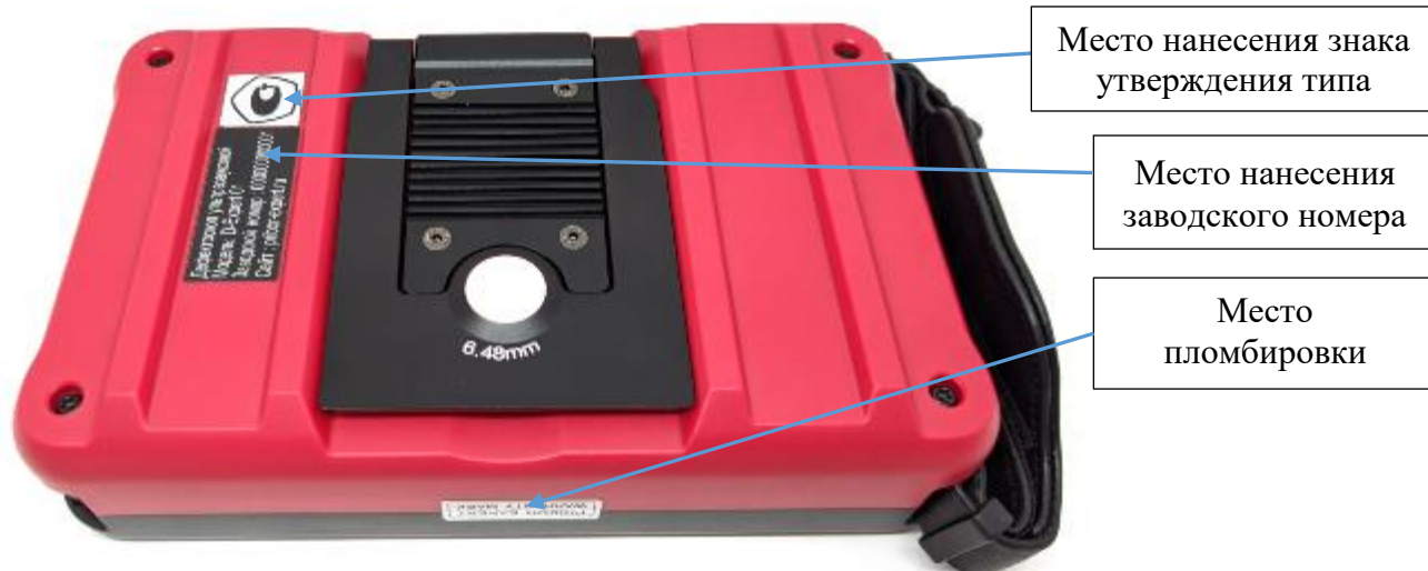
Рисунок 2 – Схема пломбировки от несанкционированного доступа и места нанесения заводского номера и знака утверждения типа
