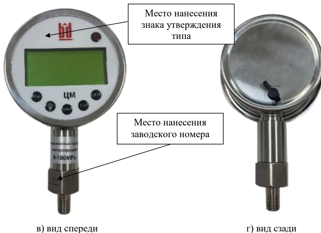
Рисунок 1 – Общий вид манометров с указанием места нанесения знака утверждения типа и места нанесения заводского номера
