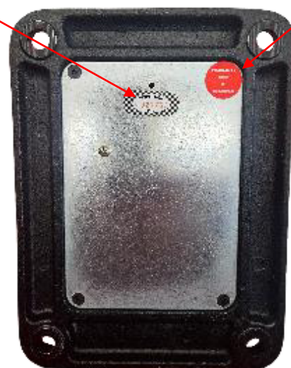
Рисунок 4 – Место пломбирования измерителей крутящего момента силы CARBON
