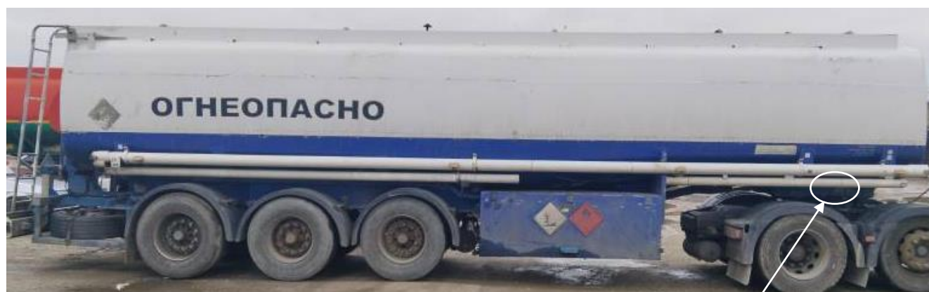
Рисунок 1 – Общий вид полуприцепа-цистерны ELLINGHAUS STA-24-39/6 зав. № 851133 и место нанесения заводского номера
