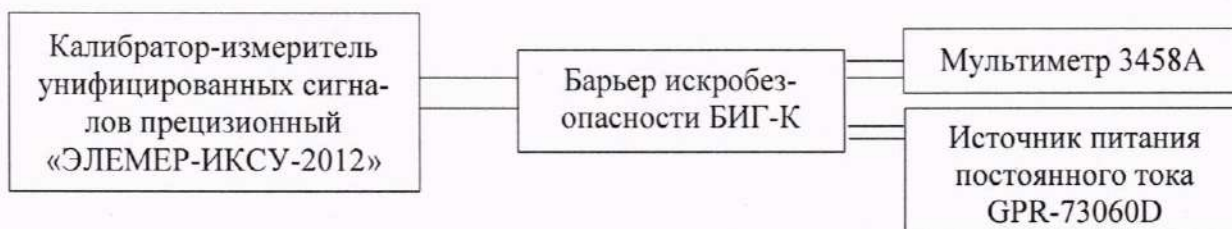
Рисунок 3 – Схема подключения для определения основной приведенной к диапазону выходного сигнала погрешности преобразований входного сигнала в виде силы и напряжения постоянного тока в выходной сигнал
