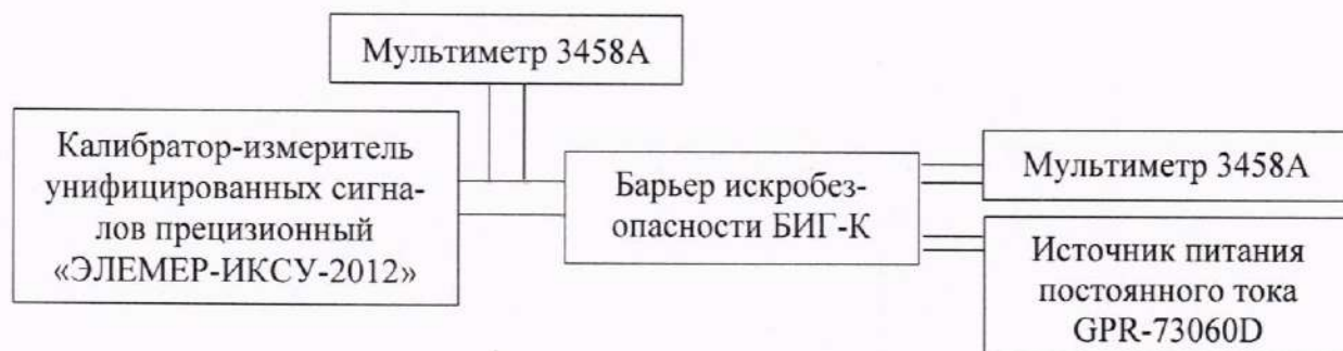
Рисунок 2 – Схема подключения для определения основной приведенной к диапазону выходного сигнала погрешности преобразований входного сигнала от преобразователей термоэлектрических в выходной сигнал
