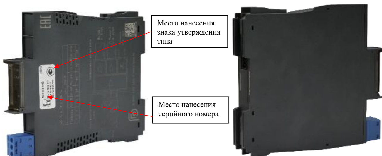
Рисунок 1 – Общий вид барьеров с указанием места нанесения серийного номера и места нанесения знака утверждения типа
