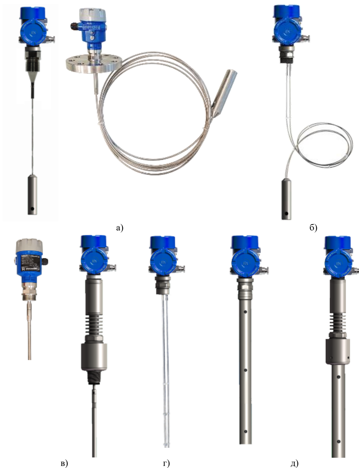
Рисунок 1 – Общий вид уровнемеров: а) с тросовым зондом, б) с двойным с тросовым зондом, в) со стержневым зондом, г) с двойным стержневым зондом, д) с коаксиальным зондом
