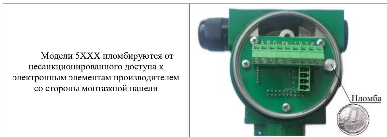
Рисунок 6 – Место нанесения пломбы от несанкционированного доступа к электронным элементам датчика
