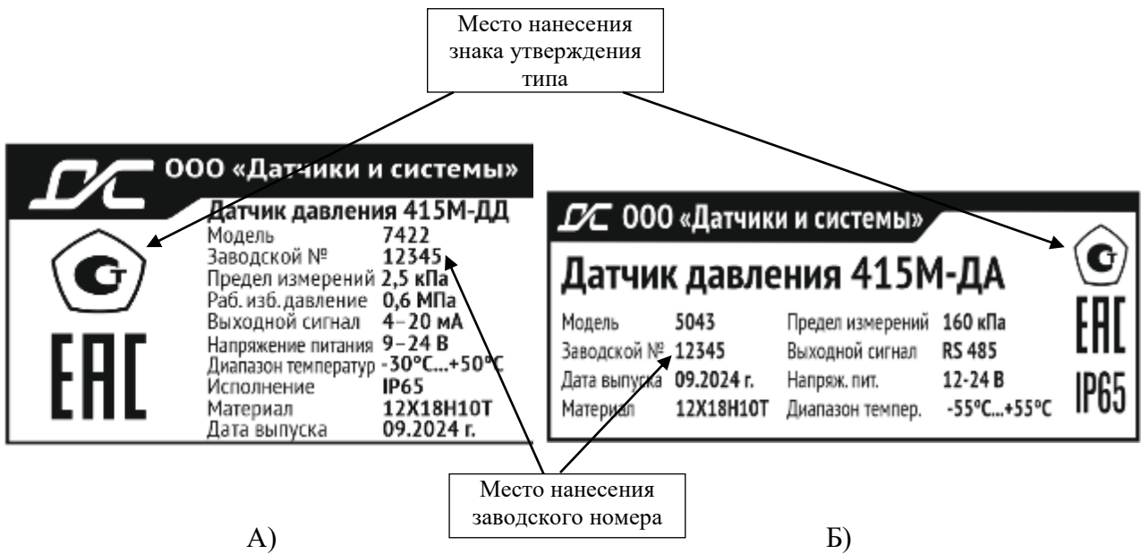
Рисунок 4 – Место нанесения заводского номера и знака утверждения типа на маркировочной наклейке (А) и на металлическом шильдике (Б) датчика
