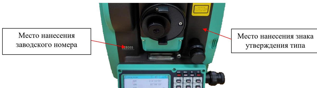
Рисунок 2 – Места нанесения заводского номера и знака утверждения типа
