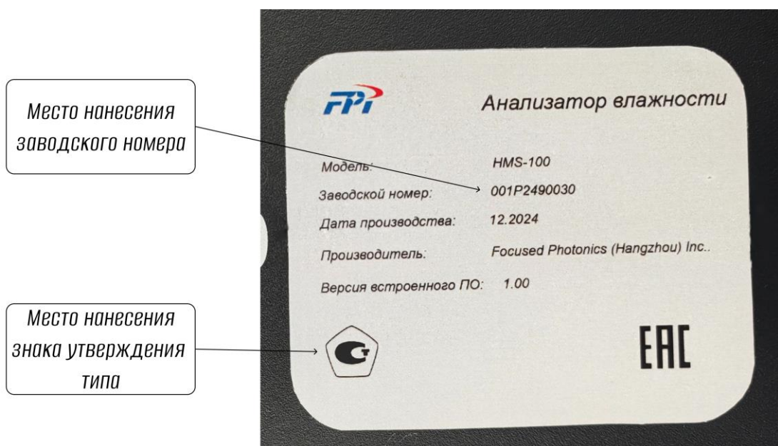
Рисунок 2 – Идентификационная табличка анализаторов с указанием мест нанесения заводского номера и знака утверждения типа
