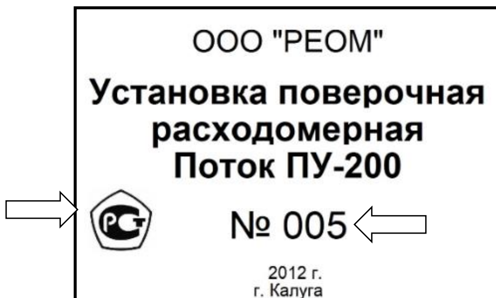
Рисунок 3 – Обозначения мест нанесения знака утверждения типа и заводского номера
