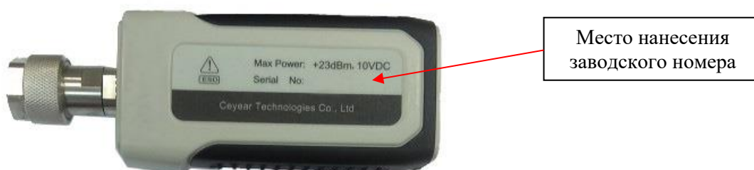
Рисунок 4 – Вид преобразователя измерительного с обозначением места нанесения заводского номера
