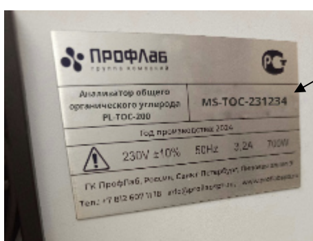
Рисунок 2 – Место нанесения серийного номера на анализаторы общего органического углерода PL-TOC-200
