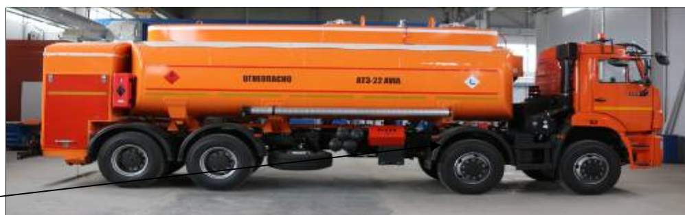
Рисунок 1 – Общий вид автотопливозаправщиков АТЗ
