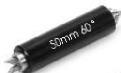
Рисунок 5 – Общий вид установочных мер для микрометров модификаций МВМ, МВМЦ
