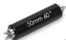
Рисунок 6 – Общий вид установочных мер для микрометров модификаций МВМд, МВМЦд
