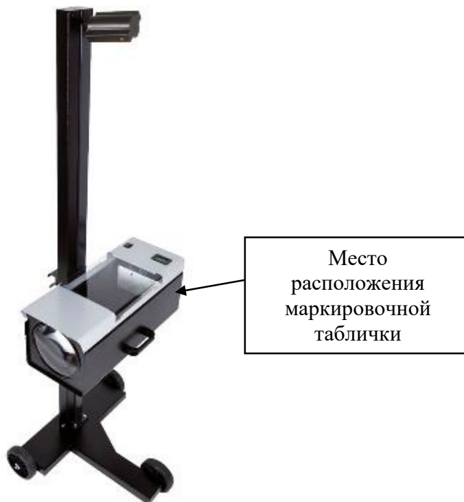
Рисунок 1 – Общий вид приборов для измерений параметров света фар автотранспортных средств HL
