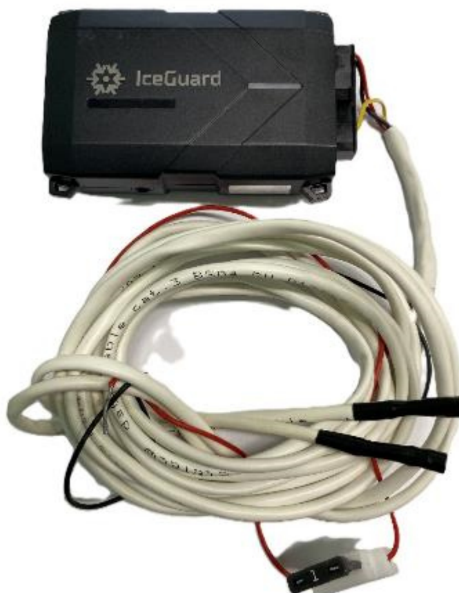
Рис. 1. Общий вид регистратора температуры и параметров работы рефрижератора IceGuard
