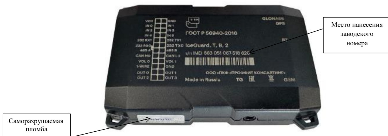
Рис. 2. Вид маркировочной таблицы регистратора температуры и параметров работы рефрижератора IceGuard
