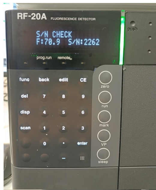
Рисунок 8 – Общий вид детектора флуориметрического RF-20A
