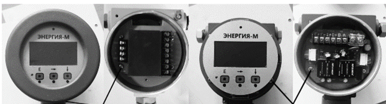
Рисунок 2 – Схема пломбирования расходомеров-счетчиков
