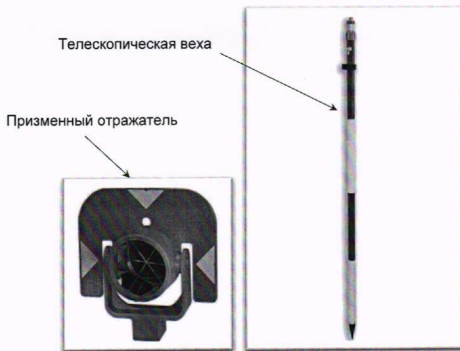
Рисунок А.1 – Веха телескопическая с призмным отражателем
