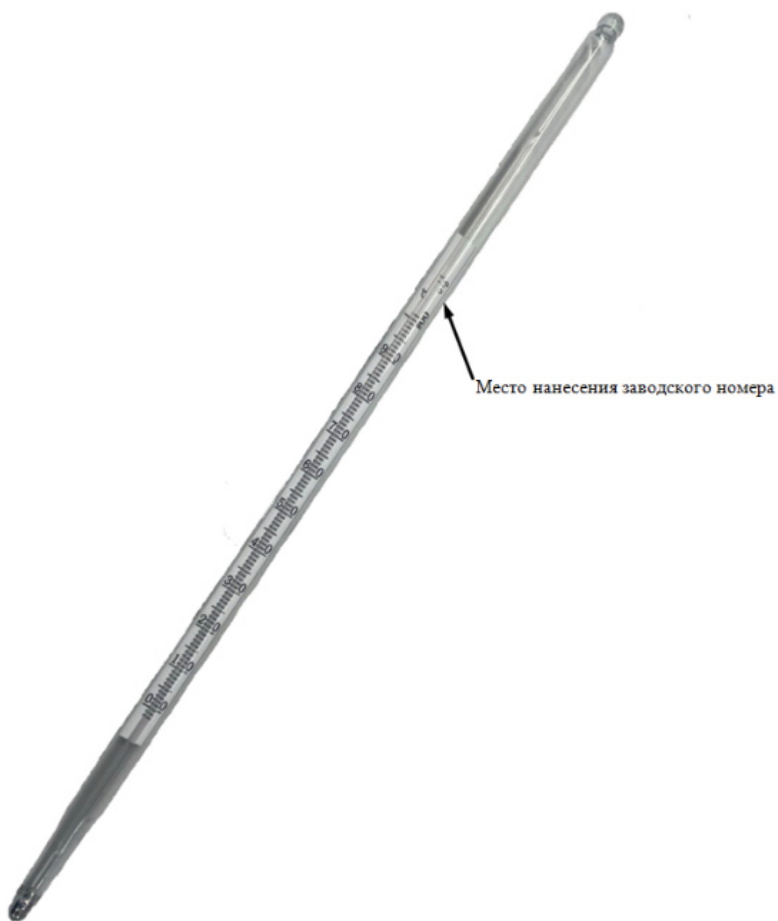
Рисунок 1 – Общий вид термометров стеклянных лабораторных ТЛ модификация ТЛ-2
