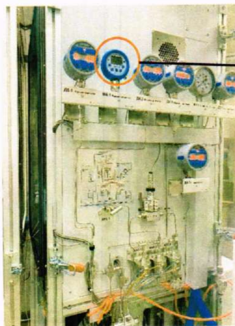
Рисунок 2 – Внешний вид подключения эталонного датчика давления при определении относительной погрешности измерений избыточного давления в блоке порового давления и в блоке порового противодействия
