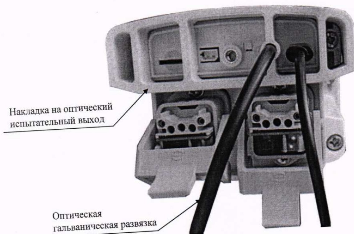
Рисунок Б.4 - Подключение ББ к ФСУ с применением накладки
