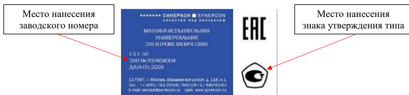
Рисунок 8 – Место нанесения заводского номера и знака утверждения типа на примере маркировочной таблички машины ES-L.50
