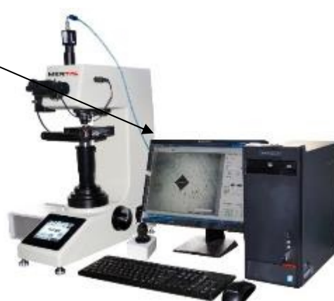
Рисунок 6 – Общий вид твердомеров Виккерса MERTIS MHV-10Z/V2.0, MERTIS MHV-50Z/V2.0, MERTIS MHV-10Z/V3.0, MERTIS MHV-50Z/V3.0
