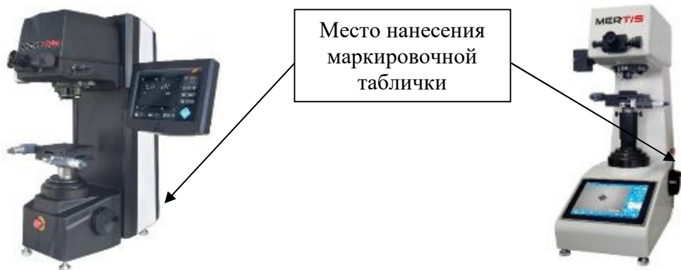
Рисунок 3 – Общий вид твердомеров Виккерса MERTIS QHVT-10Z, MERTIS QHVT-50Z
