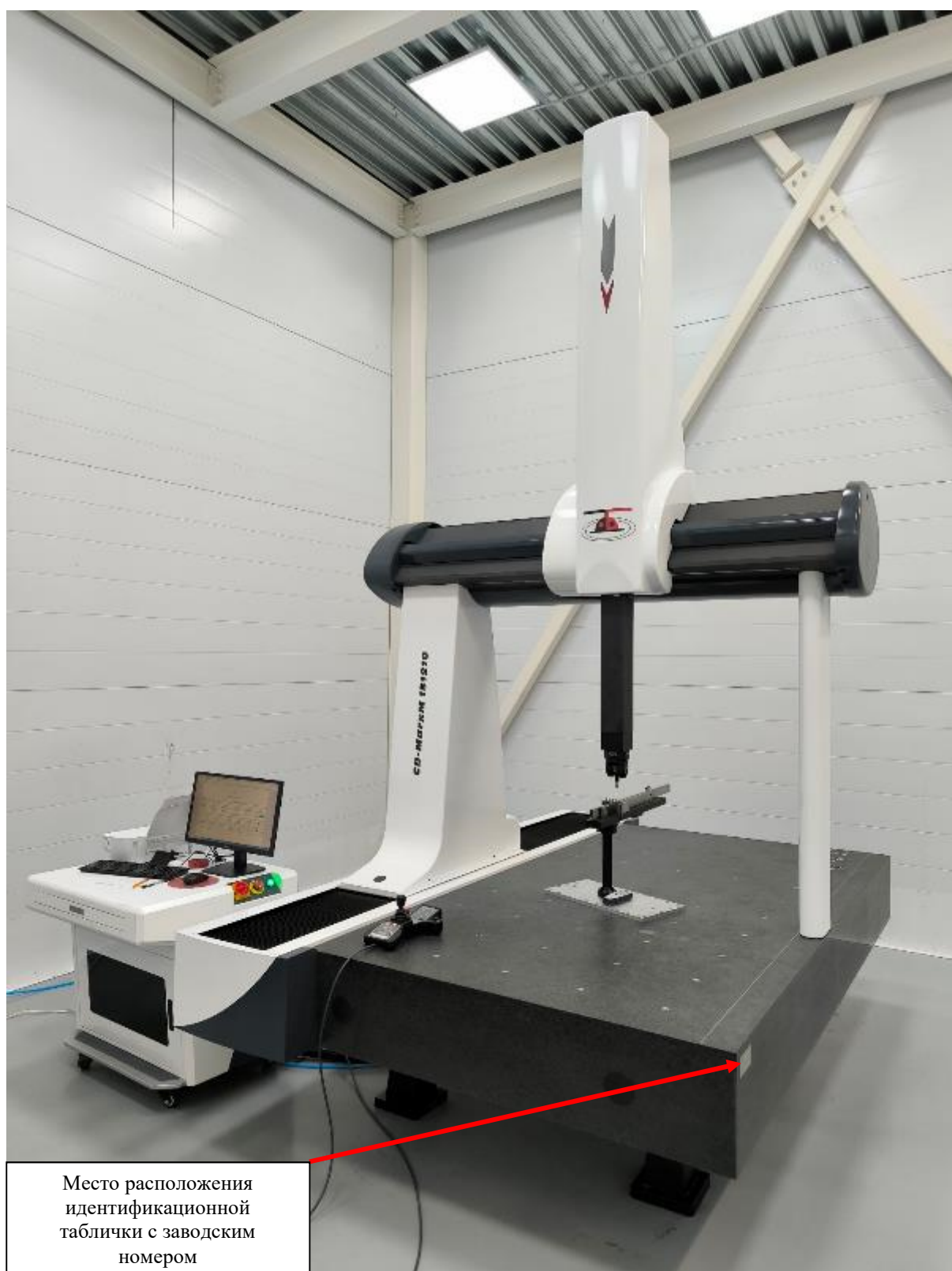
Рисунок 1 – Общий вид машины координатно-измерительной CD-MarxM 151210
