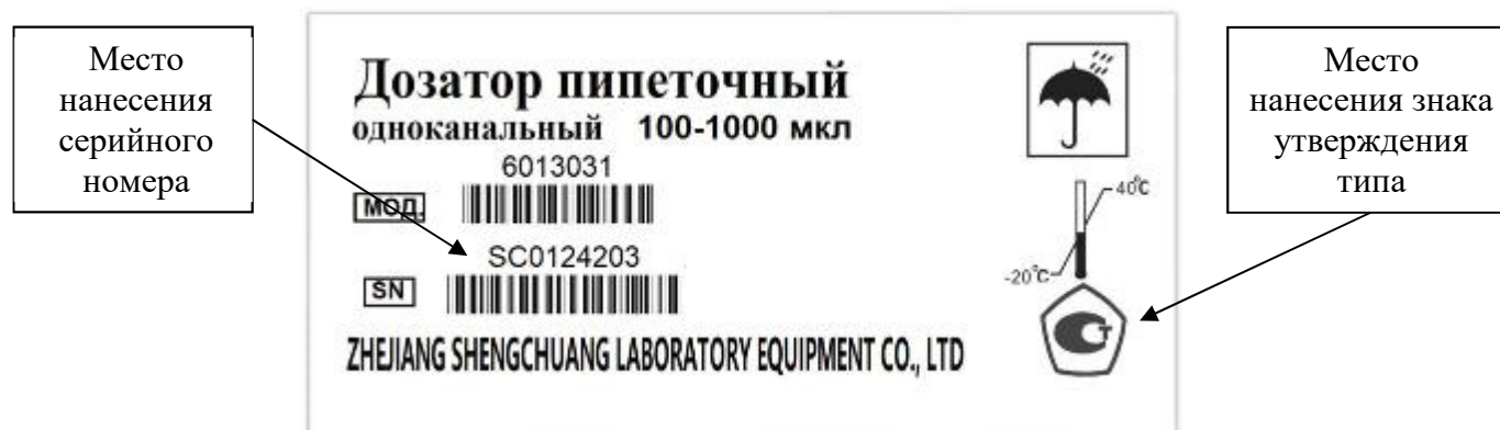
Рисунок 3 – Общий вид маркировочной этикетки дозаторов
