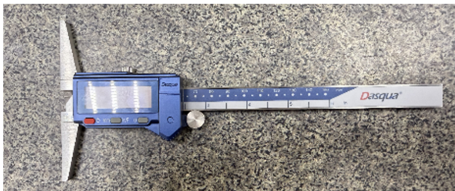
Рисунок 6 – Общий вид штангенглубиномеров модели ШГЦ со скошенным торцом штанги
