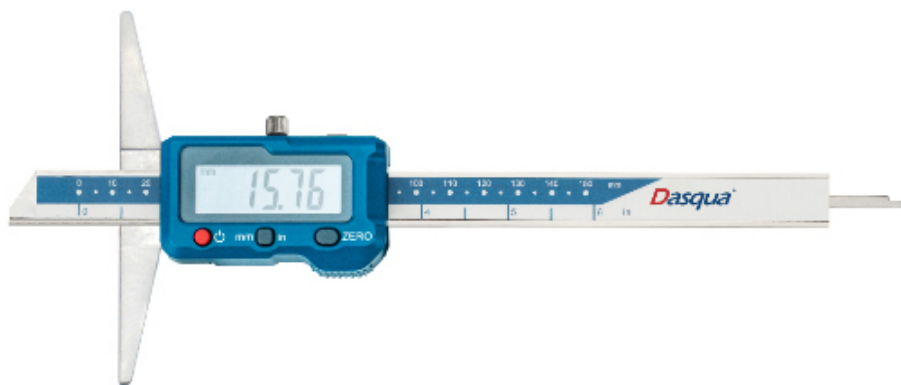
Рисунок 12 – Общий вид штангенглубиномеров модели ШГЦ со скошенным торцом штанги
