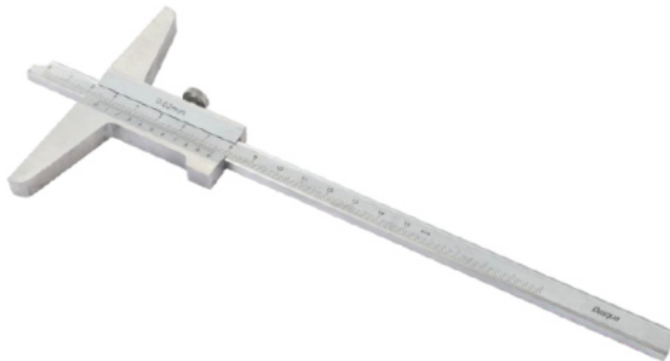
Рисунок 1 – Общий вид штангенглубиномеров модели ШГ со скошенным торцом штанги
