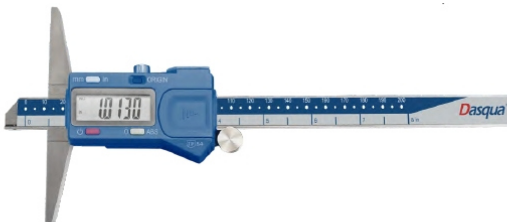
Рисунок 10 – Общий вид штангенглубиномеров модели ШГЦ со скошенным торцом штанги
