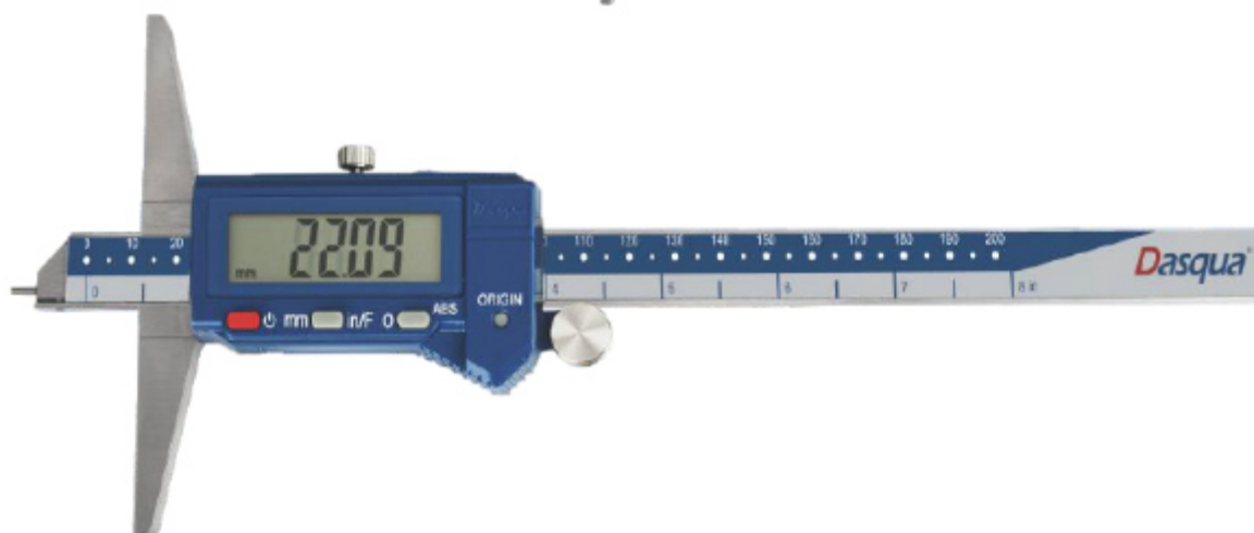
Рисунок 14 – Общий вид штангенглубиномеров модели ШГЦ с цилиндрическим тоцем штанги
