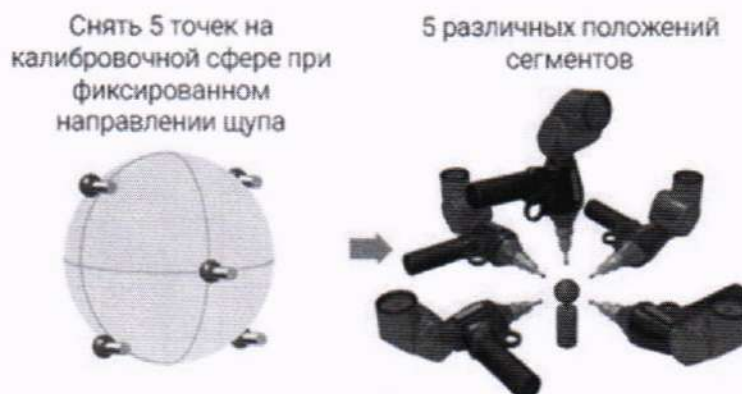
Рисунок 1 – Расположение пяти измеряемых точек и пять различных положений сегментов машин относительно сферы
