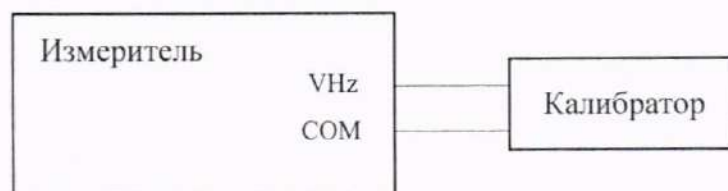
Рисунок 3.1 – Схема подключений для определения абсолютной основной погрешности измерений напряжения постоянного/переменного тока (для модификации VERDO IH6301)
