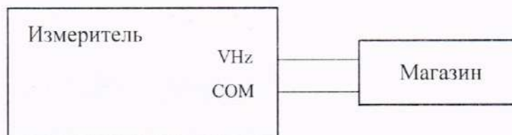
Рисунок 4.2 – Схема подключений для определения абсолютной основной погрешности измерений электрического сопротивления постоянному току (для модификации VERDO IH6301)
