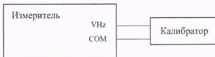
Рисунок 5 – Схема подключений для определения абсолютной основной погрешности измерений частоты переменного тока (для модификации VERDO IH6301)
