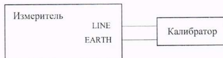
Рисунок 3.3 – Схема подключений для определения абсолютной основной погрешности измерений напряжения постоянного/переменного тока (для модификации VERDO IH6201)
