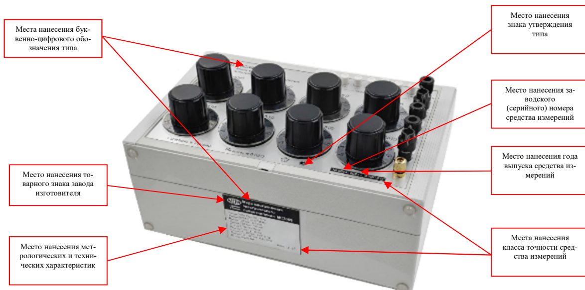
Рисунок 1 – Фотография общего вида с указанием мест нанесения буквенно-цифрового обозначения типа, метрологических и технических характеристик, товарного знака изготовителя, знака утверждения типа, цифрового обозначения класса точности, заводского (серийного) номера, года выпуска, однозначно идентифицирующих каждый экземпляр средства измерений
