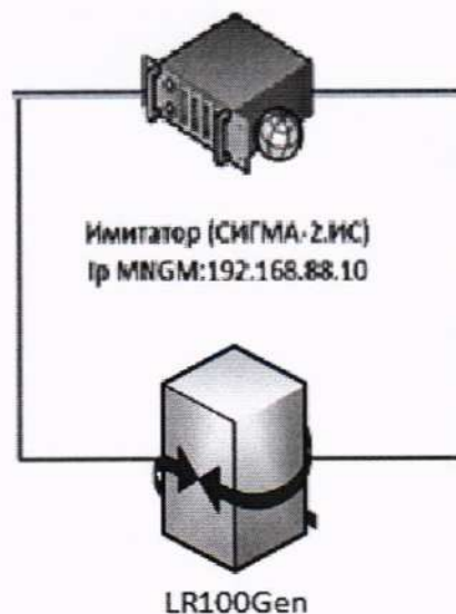
Рисунок 4 – Блок-схема определения погрешности измерений средней задержки прибором
