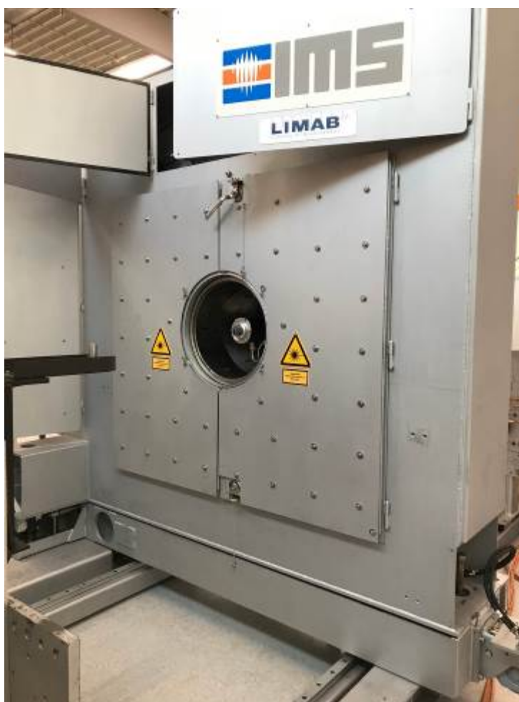
Рисунок 1 – Общий системы измерений толщины стенки и внешнего диаметра 136396-9
