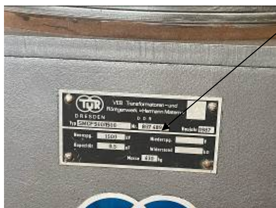
Рисунок 1 – Общий вид делителя с обозначением места пломбирования и места нанесения заводского номера
