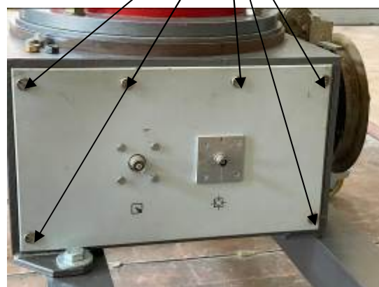
Рисунок 1 – Общий вид делителя с обозначением места пломбирования и места нанесения заводского номера
