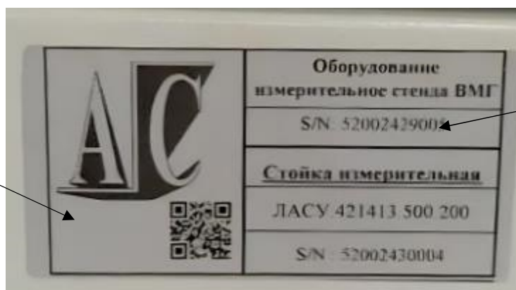
Рисунок 3 – Информационная табличка с заводским номером, место нанесения знака утверждения типа (на стойке измерительной)
