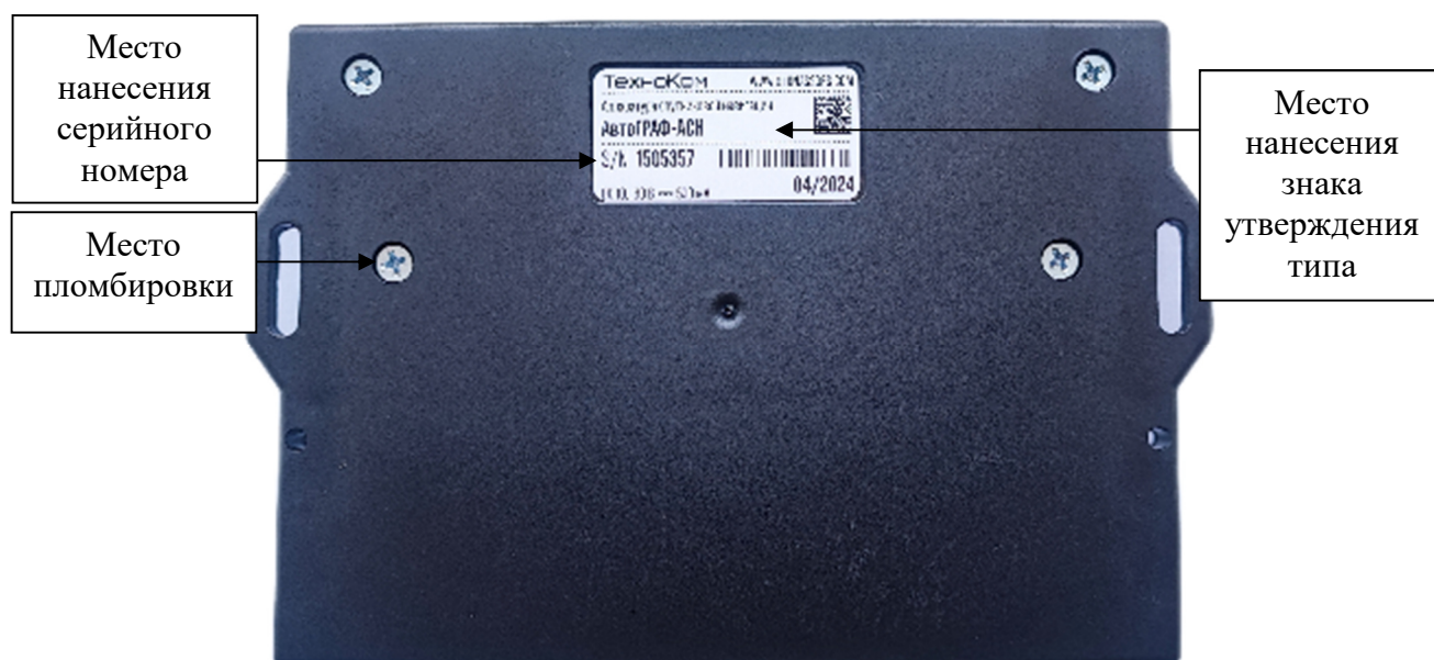
Рисунок 2 – Общий вид аппаратуры спутниковой навигации АвтоГРАФ-АСН (тыльная сторона)
