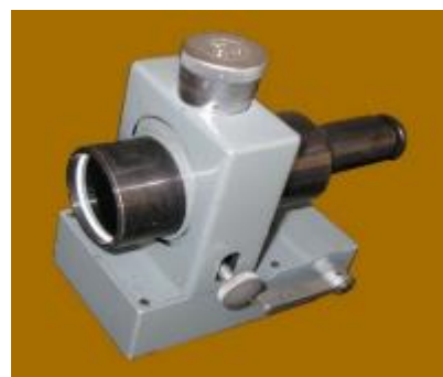
г) Визирная приемная система
