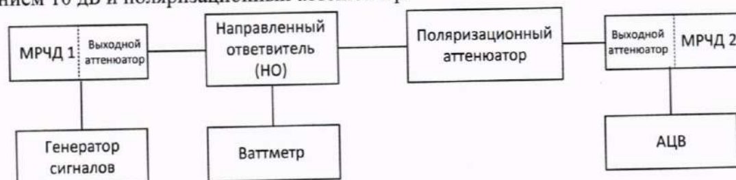
Рисунок 2 – Схема определения нелинейности приемников L
