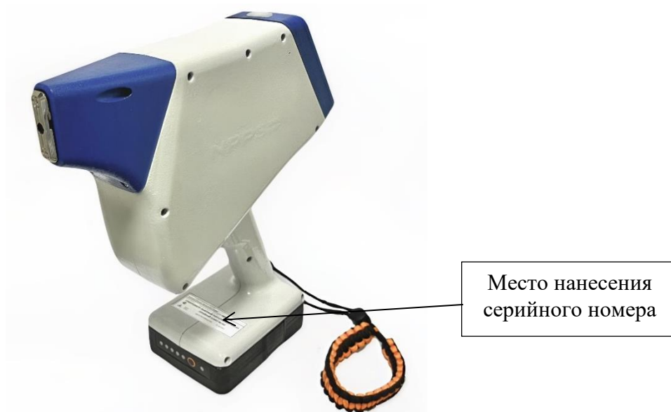
Рисунок 2 – Место нанесения серийного номера на спектрометр
