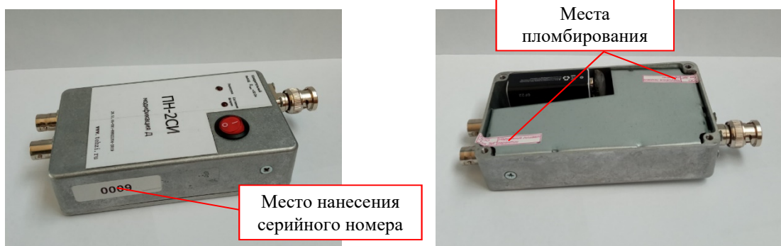
Рисунок 2 – Общий вид пробников модификации Д, с указанием мест пломбирования и места нанесения серийного номера
