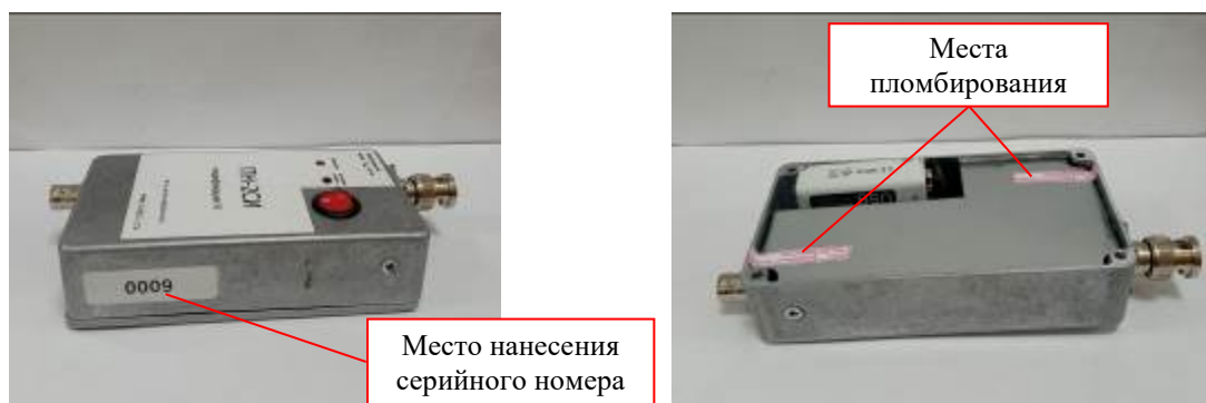
Рисунок 1 – Общий вид пробников модификации Н, с указанием мест пломбирования и места нанесения серийного номера
